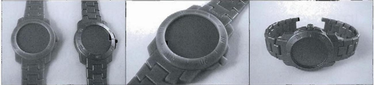
Fig. 2 : Une montre ainsi que son bracelet. Particularité de ce dernier, ce procédé de prototypage rapide permet de créer des bracelets déjà assemblés
