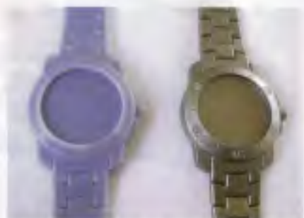
Une montre ainsi que son bracelet. Particularité de ce dernier, ce procédé de prototypage rapide permet de créer des bracelets déjà assemblés
