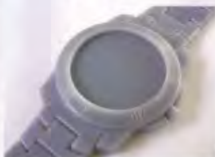
Une montre ainsi que son bracelet. Particularité de ce dernier, ce procédé de prototypage rapide permet de créer des bracelets déjà assemblés
